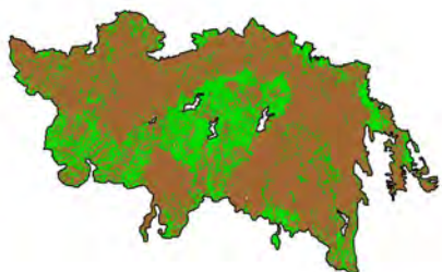
Figura 4. Clasificación SVM sobre imagen falso color RGB. En color marrón la zona quemada y en color verde la zona no quemada.
