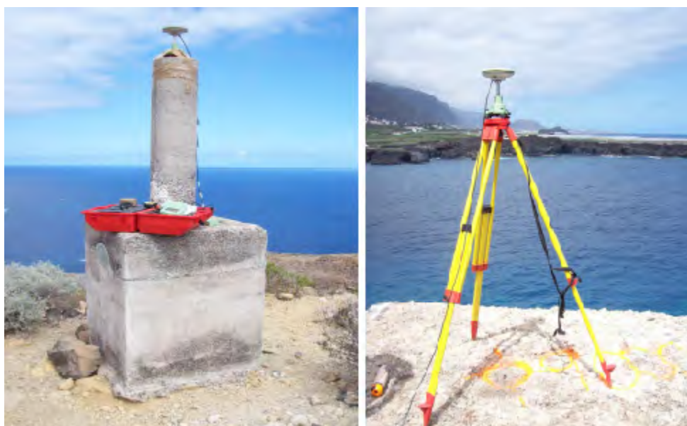
Figura 2. GPS en vértice geodésico y en zona base costera
