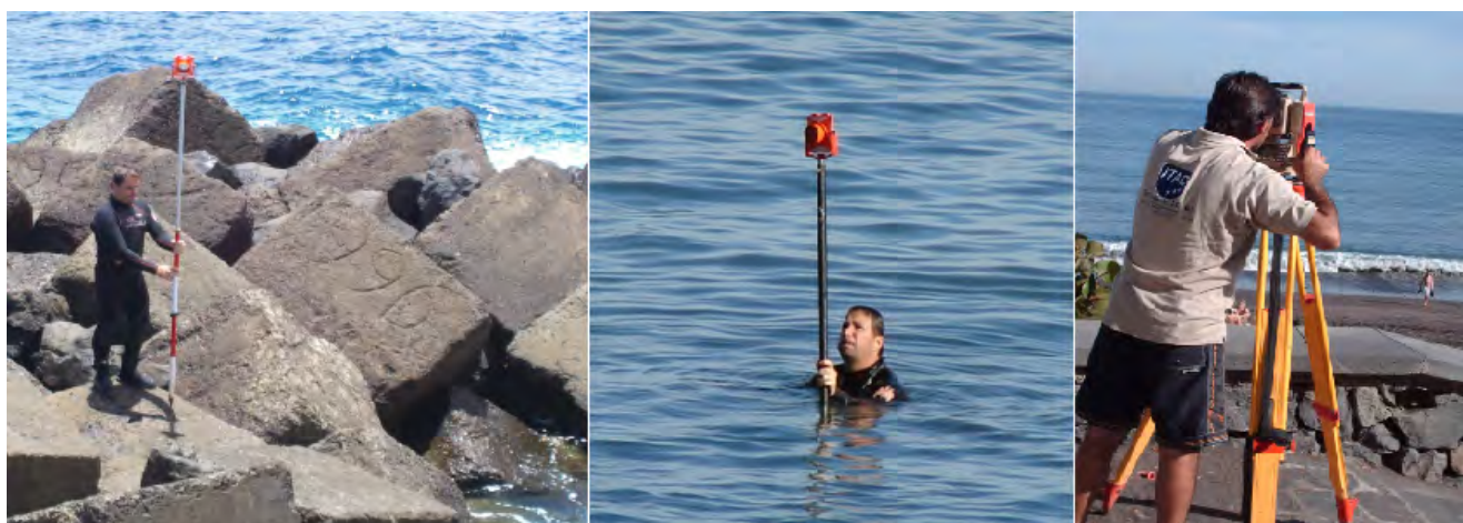
Figura 5. Técnico y auxiliar realizando levantamiento topográfico de la zona intermareal
