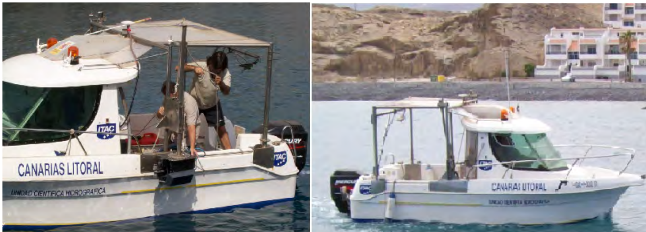
Figura 4. Embarcación Canarias Litoral, realizando una batimetría costera
