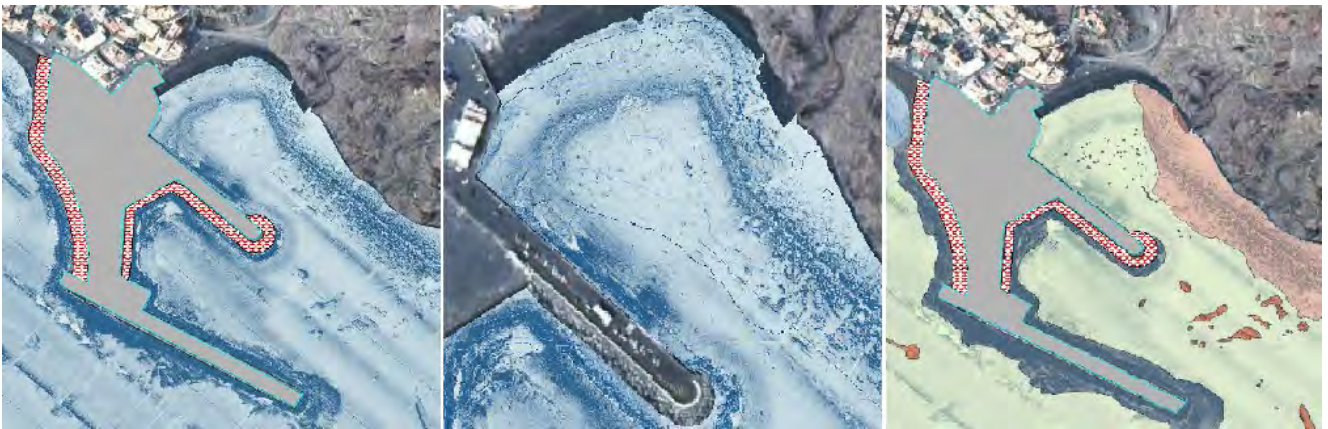
Figura 7. Sonogramas obtenidos con sonda multihaz, donde se aprecian zonas de rocas, arena, amarres de fondo y cadenas.
