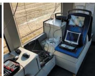
Fot. 5. Stanowisko sterowania autonomicznego podczas testów (fot. M. Górowski)
