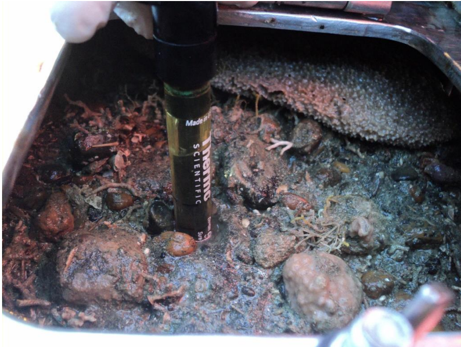
Figura 6.5.5 Vista de parte superior de la compuerta especial de la Draga Van Veen confeccionada para poder realizar mediciones REDOX en muestra no perturbada. Se observa la sonda REDOX THERMO introducida en limos arcillosos no perturbados.
