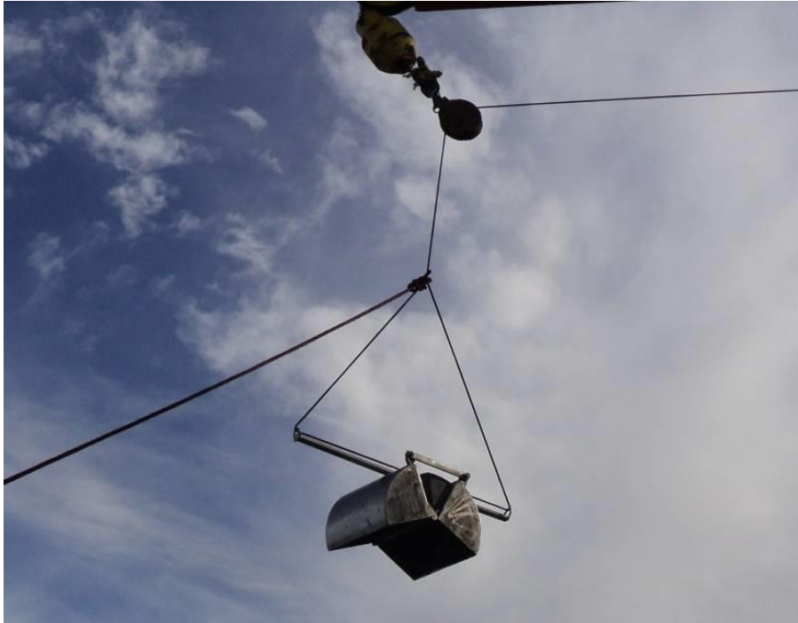
Figura 6.5.4 Draga Van Veen, desplegada por la banda de babor, lista para ser lanzada.
