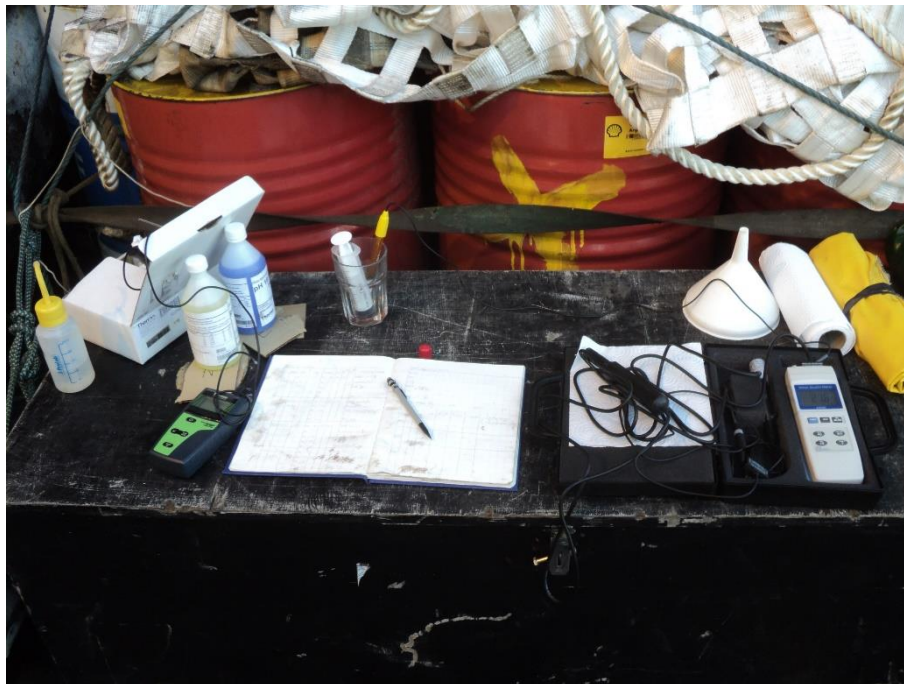
Figura 6.5.12 Laboratorio montado sobre cubierta a los fines de poder realizar las determinaciones "in situ" de potencial redox (sobre sedimentos), pH y Oxígeno Disuelto (sobre muestras de agua). Campaña 2014.
