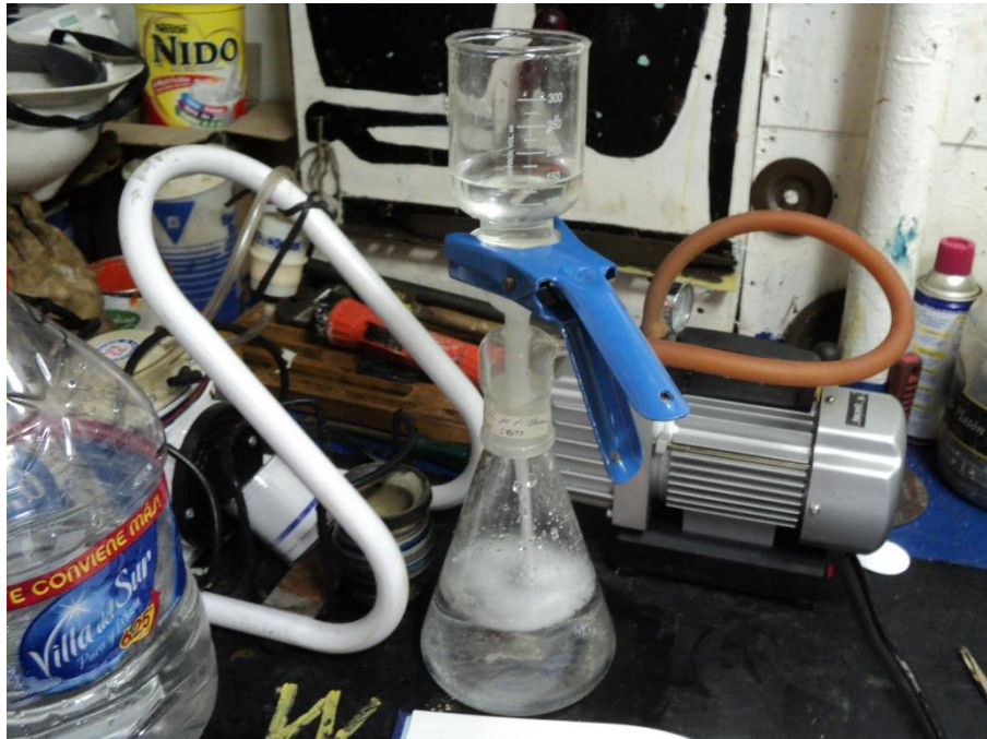
Figura 6.5.12 Laboratorio montado sobre cubierta a los fines de poder realizar las determinaciones "in situ" de potencial redox (sobre sedimentos), pH y Oxígeno Disuelto (sobre muestras de agua). Campaña 2014.
