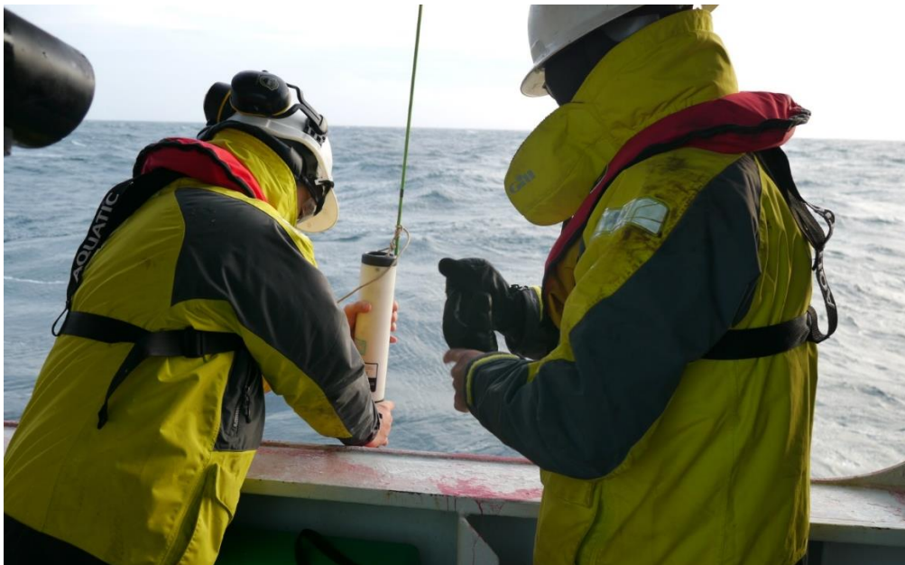
Figura 6.5.16 Sensor OBS 3A colocado al final de la línea del casting.
