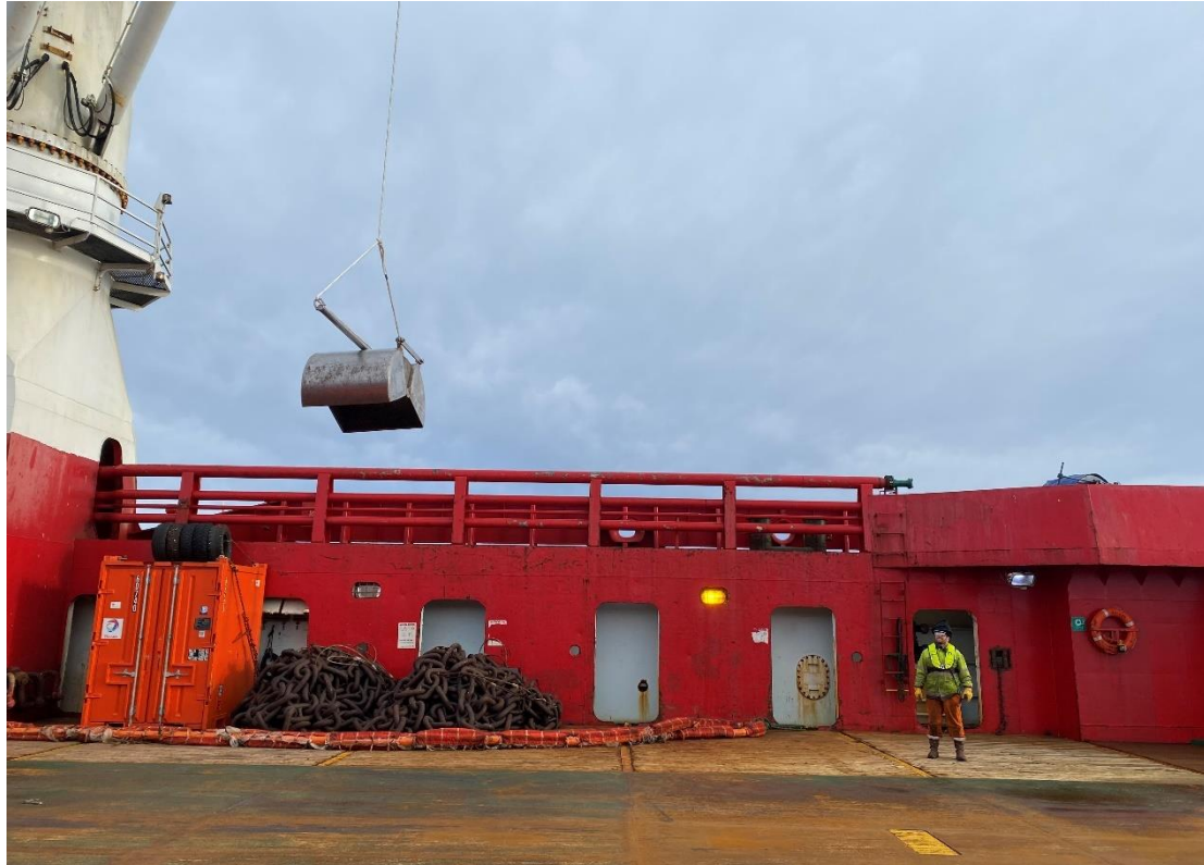
Figura 6.6.3 Draga Van Veen lista para iniciar maniobra de muestreo, operada desde la grúa principal del Skandi Patagonia.
