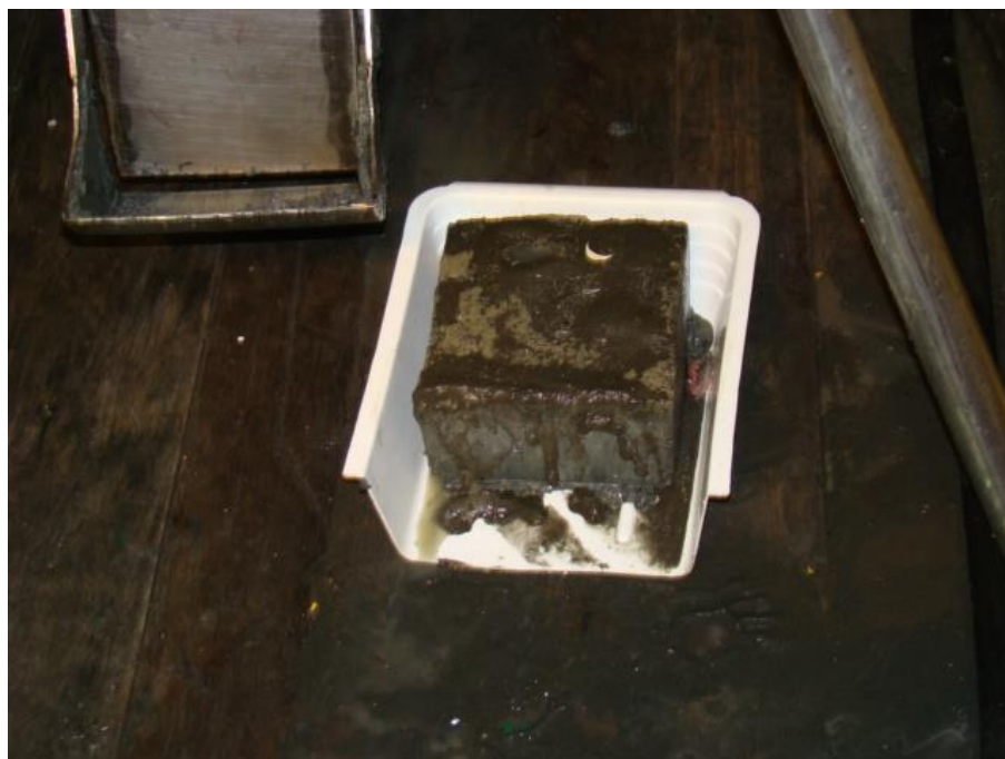
Figura 6.5.18 Muestra de sedimentos finos, tomada con muestreador tipo Box Corer, previo a la determinación del potencial redox. Se observa la superficie del fondo de mar (parte superior) y debajo unos 15 cm de muestra no perturbada en su perfil vertical.
