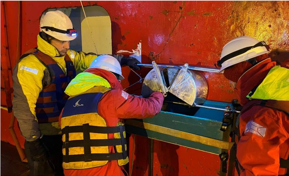
Figura 6.6.6 Tamizando muestra volcada en zaranda de 1 mm.
