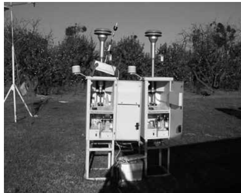
FIGURA 2. DOS RAAS2.5-100, DE LOS CUALES UNO ES DE LA UTEM, MONITOREANDO AIRE DE ZONA DE CONTROL. EL ESQUEMA REPRESENTA AL COLECTOR RASS2.5 - 100 (ANDERSEN INSTRUMENTS, INC), PARA MATERIAL PARTICULADO RESPIRABLE O INHALABLE.
