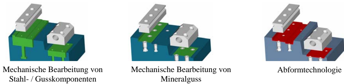
Bild 2: Befestigung von Linearführungsschienen auf Mineralgussbetten
