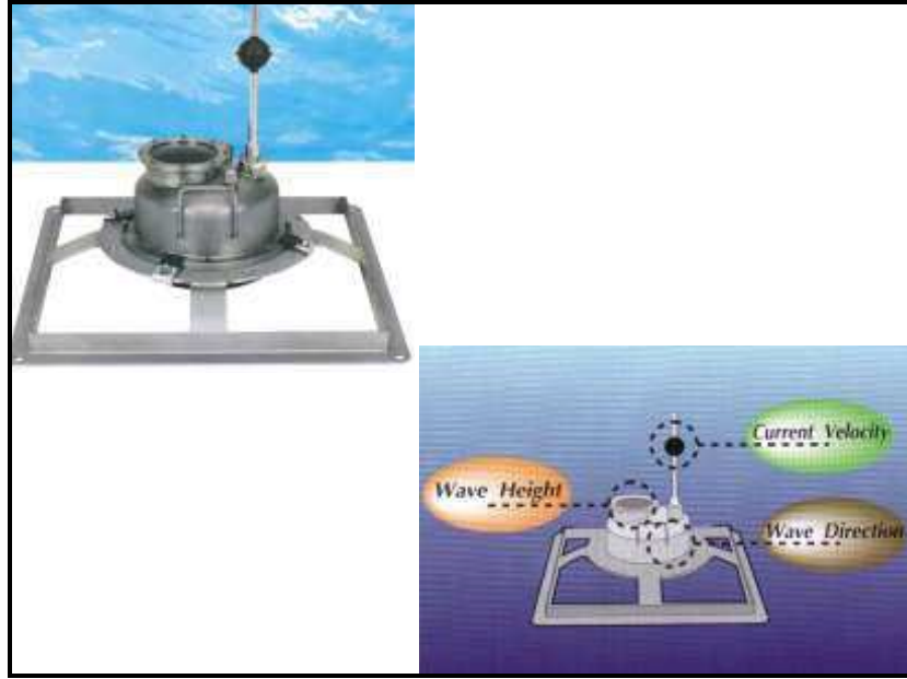
Şekil 1. Dalga ölçüm cihazı (Yüksel ve diğ. 2004)
