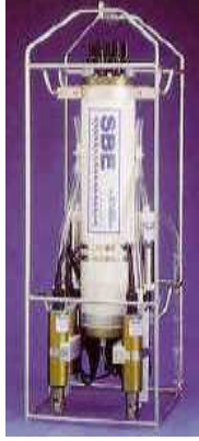
SBE 9 plus Su altı birimi C, T, ve P sensörleri
