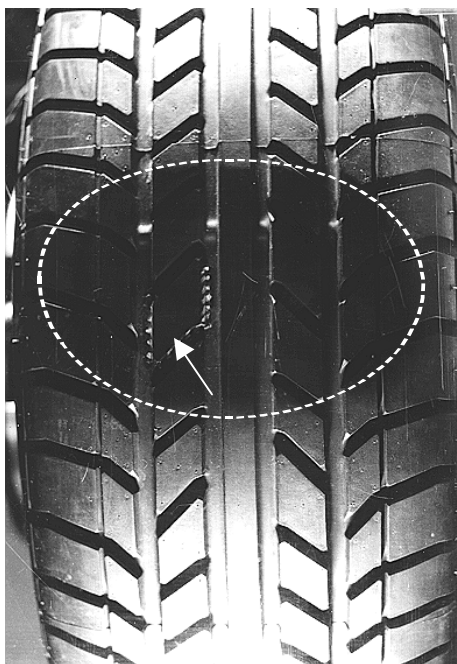
Bild 29: Versuchsreifen Pirelli P700 Z mit eingezeichnete Aufstandsfläche bei einer Radlast von 2500 N
