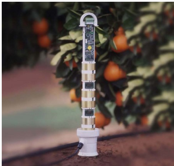
Obrázek 21 Kapacitní sonda pro měření vlhkosti půdy (zdroj web Ekotechnika).
