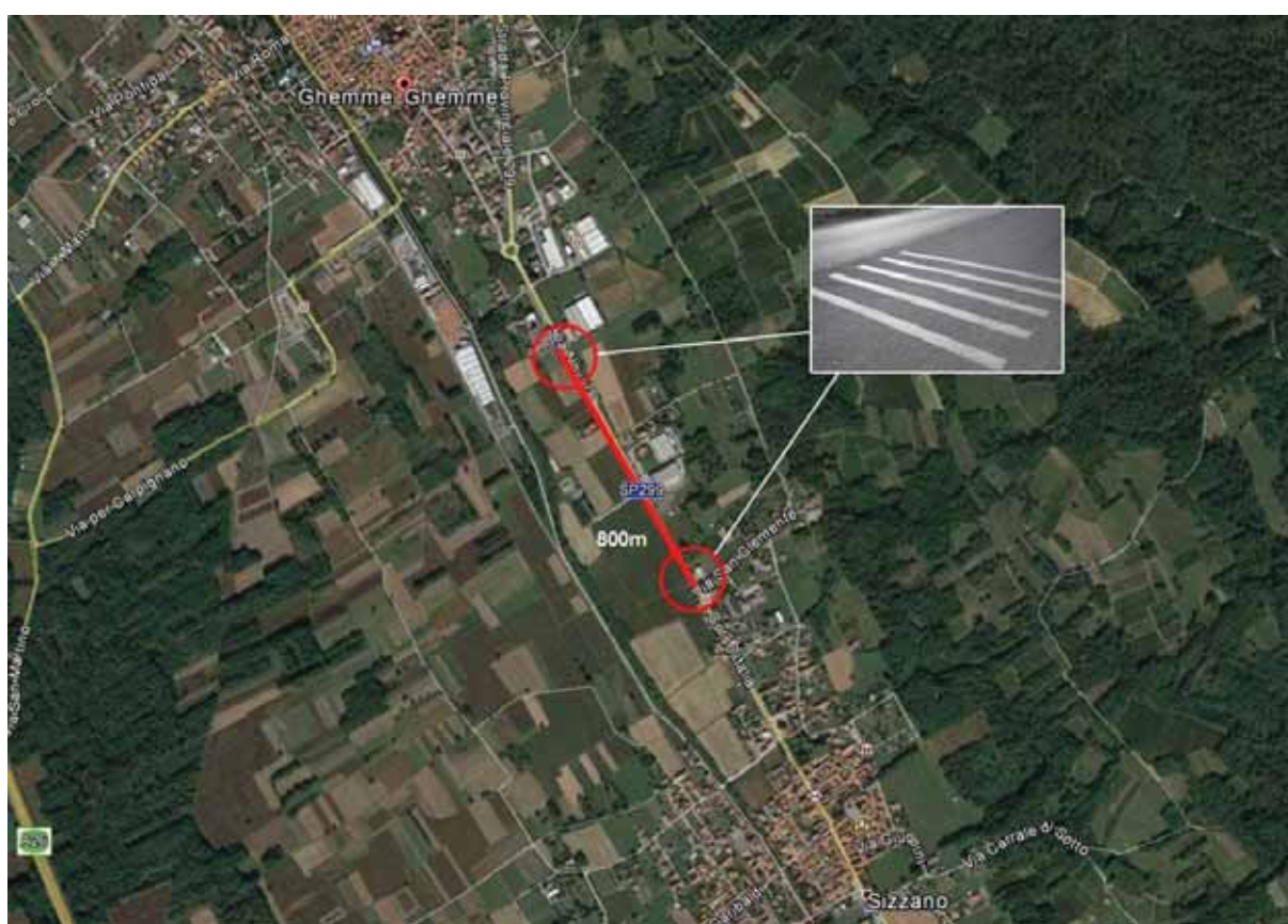
Individuazione dei punti di installazione delle bande sonore base cartografica: Google Maps
