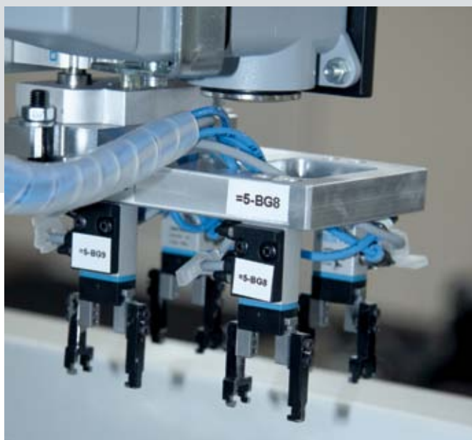
Manipulátor Festo je tvořený bezpístnicovým pohonem DGC, saněmi DGSL a vyměnitelnou úchopovou hlavicí se čtyřmi paralelními chapadly DHPS
