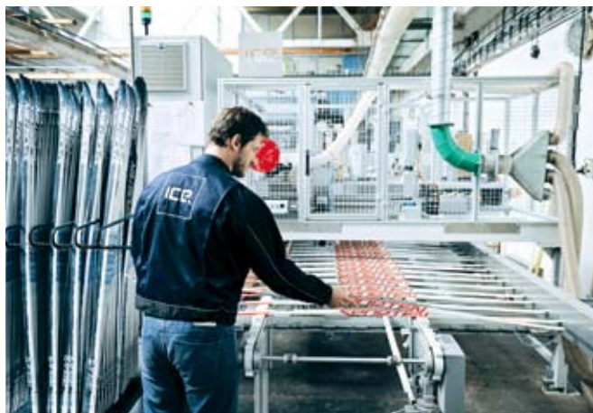
Obsluha zakládá lyže na vstupní pás. Dle rozměrů lyže se provede základní nastavení stroje, zejména přitlačné desky, ke které je lyže přitlačena pomocí kuličkových šroubů poháněných novou řadou krokových motorů OMS.
