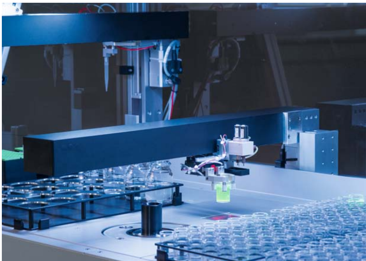
Přesné procesy pipetování: Díky kompaktním manipulačním portálům s elektrickými pohony od společnosti Festo.
