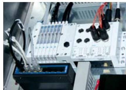
Detail jednoho z ventilových terminálů MPA-L.
