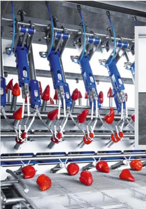
Naplní 14 500 kusů čerstvé zeleniny za hodinu: Nový multifunkční stroj na plnění předkrmových specialit od firmy KARB Maschinenbau.
