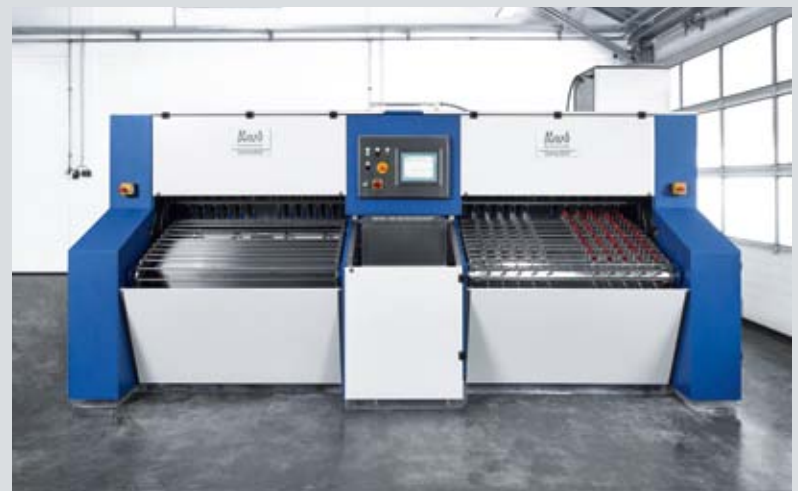
Naplní 14 500 kusů čerstvé zeleniny za hodinu: Nový multifunkční stroj na plnění předkrmových specialit od firmy KARB Maschinenbau.
