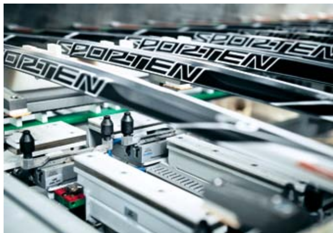
Všechny pneumatické pohyby řídí modulární pneumatický ostrov Festo, konkrétně řada MPA.
