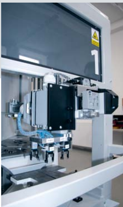
Manipulátor Festo je tvořený bezpístnicovým pohonem DGC, saněmi DGSL a vyměnitelnou úchopovou hlavicí se čtyřmi paralelními chapadly DHPS
