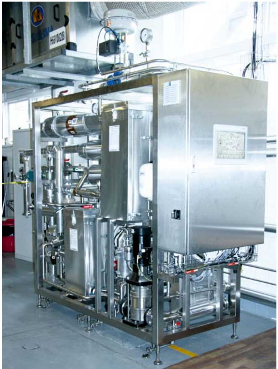
Jednotka UHT s rozvaděčem a dotykovou obrazovkou CDPX-X-A-W-13.
