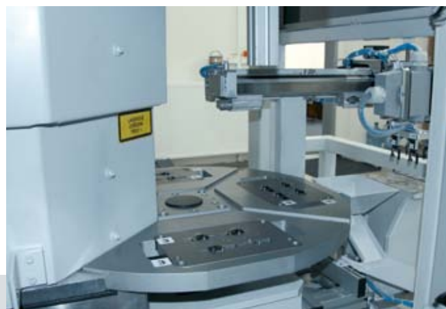
Základem zařízení je otočný čtyřpolohový pracovní stůl obsluhovaný manipulátorem Festo.
