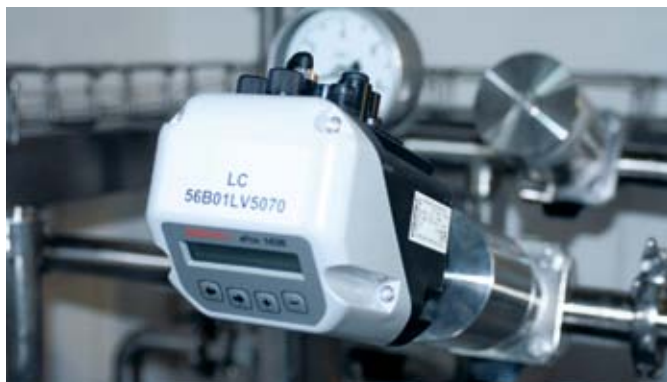
Pozicioner 1436 byl na membránový ventil Sisto namontován v dílnách Festo.
