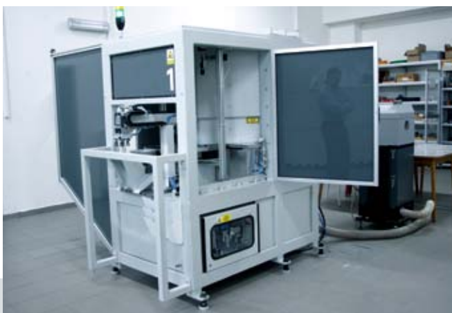
Kompaktní pracoviště (robotická buňka) pro laserové řezání tzv. inzertů. Toto zařízení získalo ocenění Produkt roku 2015 v anketě Produkt roku časopisu Control Engineering Česko.
