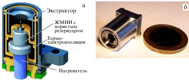
Рис. 58. (а) Схематическое изображение галлиевого nanoFEEP, (б) его внешний вид рядом с монетой в 1 евро [358].
