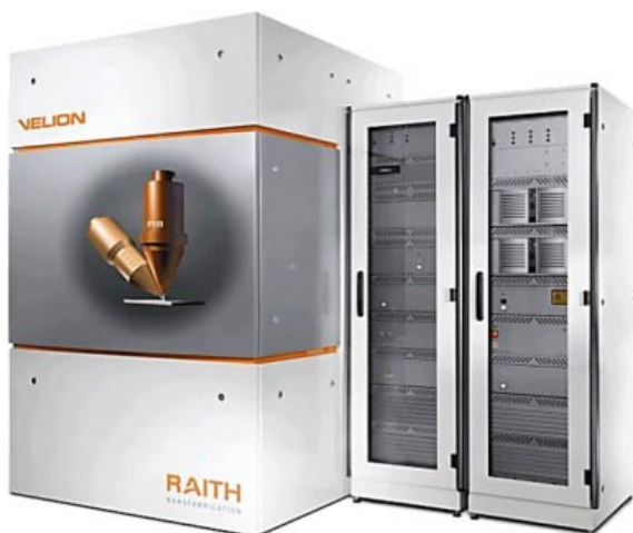
Рис. 30. Внешний вид ионно-лучевого литографа VELION [264].
