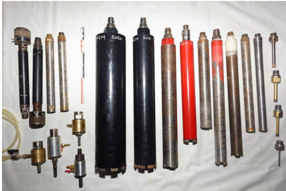
Figure 1 : Différents types de matériels utilisés (couronnes diamantées (4 à 112 mm), rallonges, têtes d'injection).
