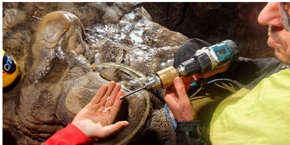
Figure 3 : Carottage de petit diamètre (ici 4 mm intérieur) mis en œuvre avec une visseuse et un pulvérisateur de jardin (Aven d'Orgnac, Ardèche). Photo S. Jaillet.
