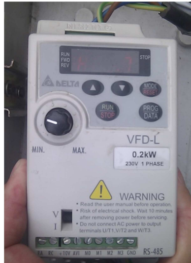
Figura 27: Variador de frecuencia programable, marca DELTA.
