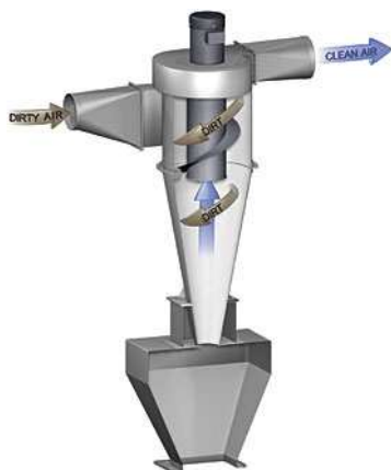
Fig. 4.6. Ejemplo de ciclón para limpiar un flujo de gas. (Fuente: http://www.uasinc.com United Air Specialist Inc es una empresa que construye y comercializa ciclones).
