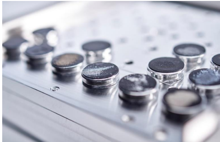
Figura 3-12 Soportes con diferentes muestras adheridas y repartidas sobre el adhesivo de carbono.
