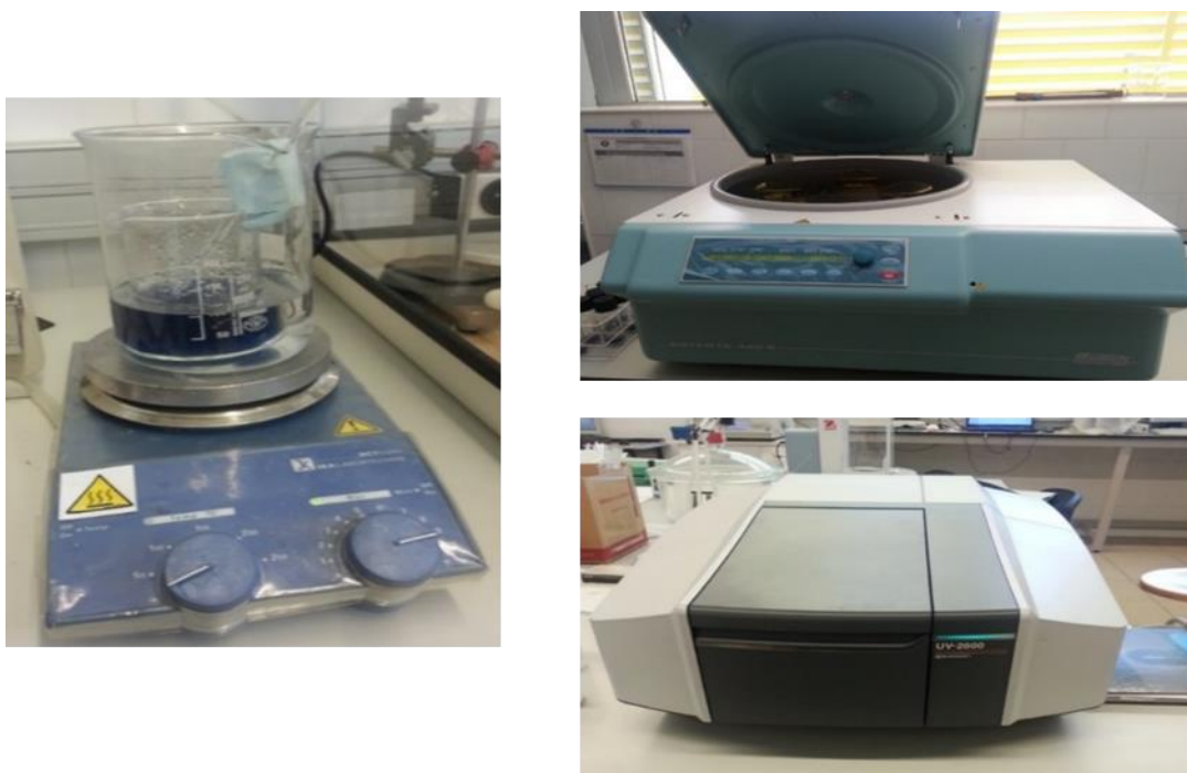
Figura 3-4 (a) Vaso de precipitado con termómetro, solución RB-5 25 \mu\text{M} y agitador magnético. (b) Centrífuga, Hettich Rotanta 460R. (c) Espectrofotómetro UV-VIS, Shimadzu UV 2600.
