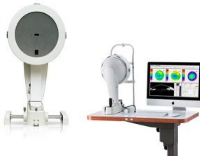
Figura 1: Pentacam, basado en el principio de Scheimpflug [3].
