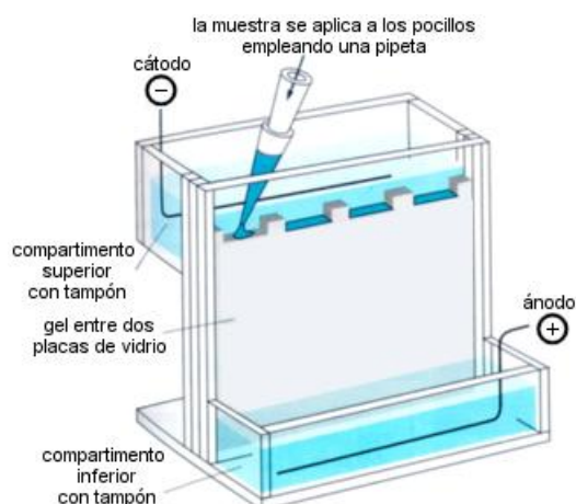
Figura 5.12. Esquema de un montaje de electroforesis vertical [41]
