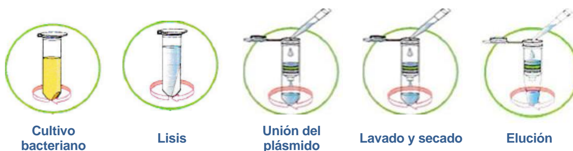
Figura 5.3. Esquema del protocolo del Illustra™ plasmidPrep Mini Spin Kit (Adaptada de [31])
