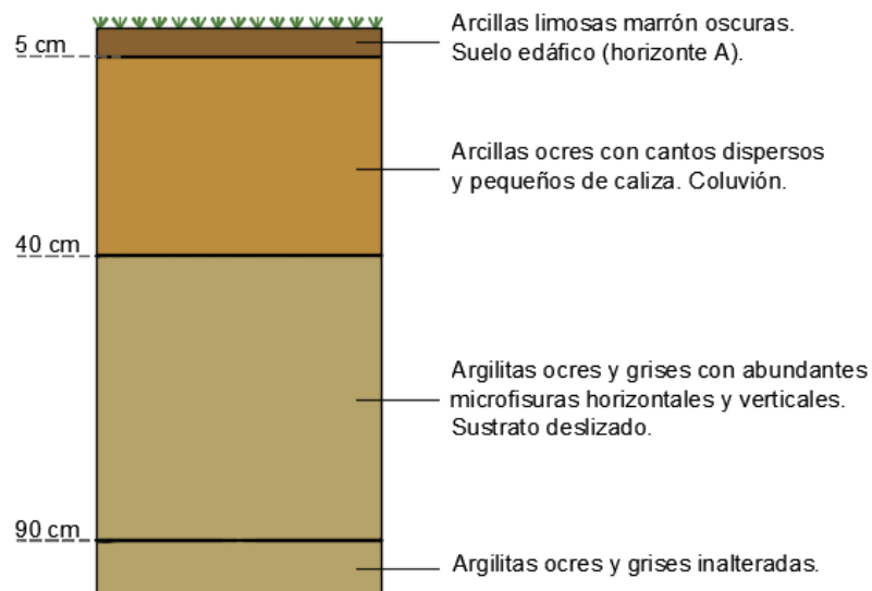
Figura 19. Estratos del suelo debajo del deslizamiento.
