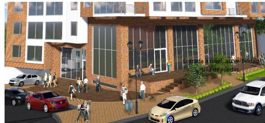
Imagen 30: aceras en calles con pendiente pronunciada, los desniveles se resuelven en la franja de borde.
