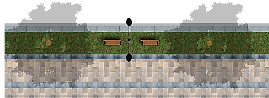
Gráfico 58: franja de servicio con piso verde totalmente permeable, el resto de las franjas tienen pisos adoquinados con factor 0.3 de permeabilidad.
