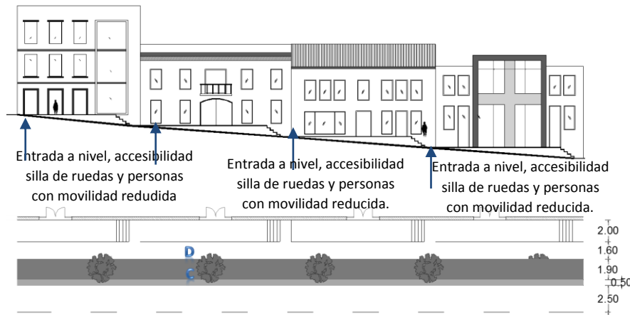
Gráfico 71: esquema en donde se puede apreciar la utilidad de la franja de borde para resolver los desniveles y acceso a las edificaciones, manteniendo la franja de circulación sin interrupciones, en el mismo plano de pendiente
