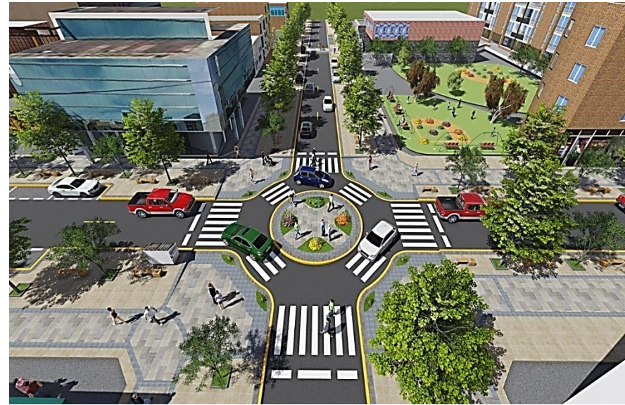
Imagen 19: intersección a nivel con rotonda entre dos colectoras locales o dos locales.
