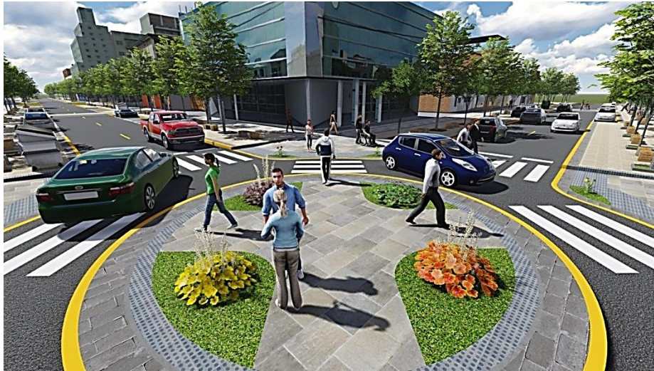
Imagen 20: rotonda en donde se puede apreciar la franja de seguridad que puede ser invadida por automotores de mayor tamaño.
