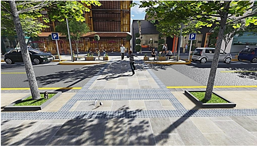
Imagen 24: plataforma en media cuadra, reduce la velocidad de los automotores y facilita el cruce de los peatones, en especial a los con movilidad reducida.
