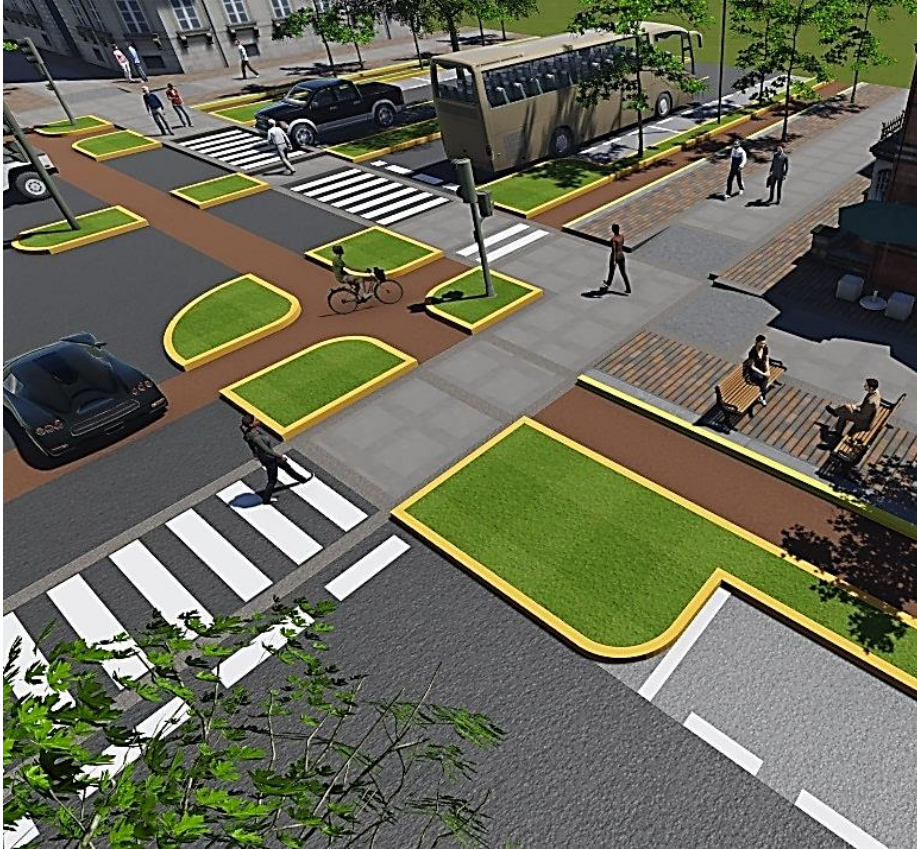
Imagen 21: detalle en donde se puede apreciar la intersección en donde se resuelven los cruces de bicicleta, peatones y automotores sin mayor conflicto
