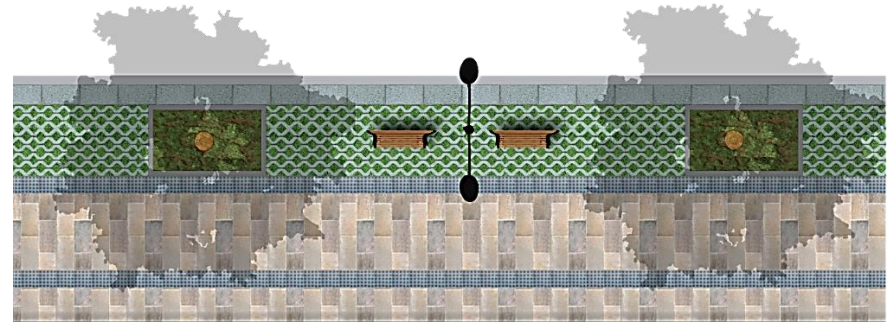
Gráfico 59: franja de servicio con piso semipermeable con factor 0.7 de permeabilidad, el resto de las franjas tienen pisos adoquinados con factor 0.3 de permeabilidad.
