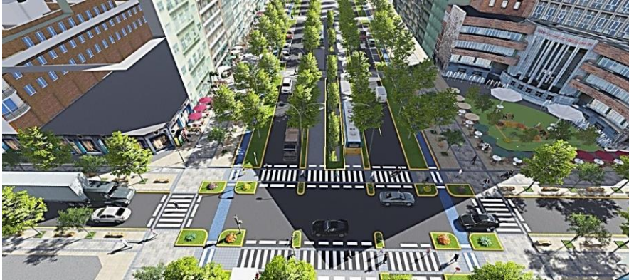
Imagen 36: intersección en donde se mantiene la continuidad de la red peatonal mediante el cruce cebra y los refugios peatonales
