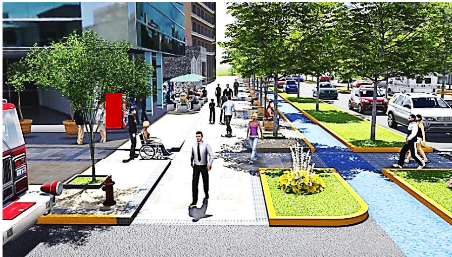
Imagen 5: franjas de borde, de circulación, servicio, de seguridad y ciclo carril en una calle colectora
