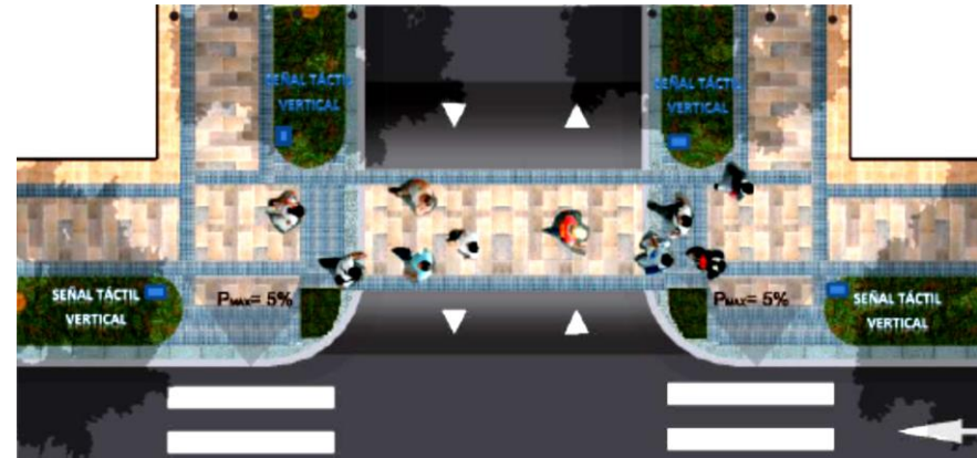
Gráfico 63: señales táctiles para personas no videntes en intersección y tramos de acera
