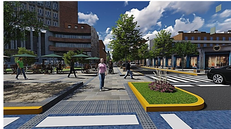
Imagen 29: pavimento podotáctil de advertencia marcando el límite de la franja de circulación peatonal, con la del tráfico rodado. Cuando existe un cruce, se colocan tres filas de adoquines seguidos. También se puede apreciar el cruce a nivel a lo largo de toda la calzada, de tal manera que se lo pueda hacer fácilmente en silla de ruedas o con movilidad reducida.
