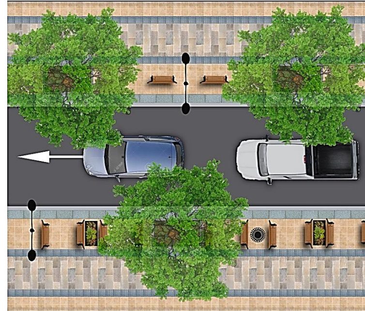
Gráfico 74: calle L1; 10,40m de ancho, con árboles de copa mediana (d=6m), proveyendo de sombra a la calle en alrededor del 30% de la superficie, en dos hileras y alternados.
