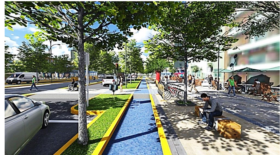
Imagen 7: carril bicicleta segregado en un solo sentido, aparcabici lateral
