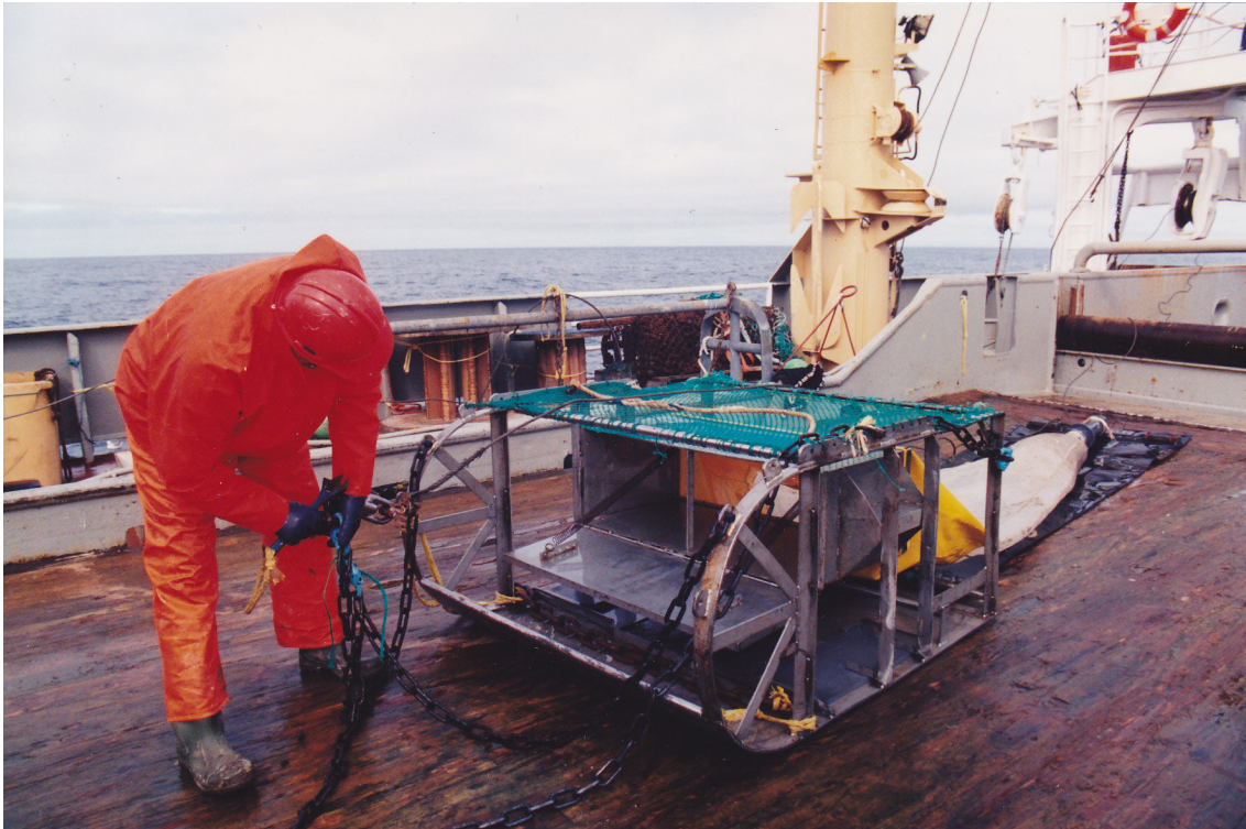
3. mynd. RP-sleði yfirfarinn fyrir slökun á dekkinu á rs. Bjarna Sæmundssyni. Ljós. Sigmar A. Steingrímsson. – The RP-sledge checked before lowering on the deck of rv. Bjarni Sæmundsson. Photo by Sigmar A. Steingrímsson.
