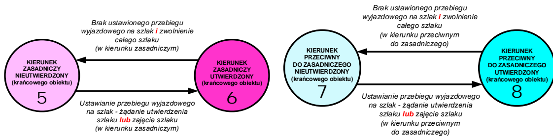
Rys. 18 Podstawowy graf stanów blokady typu OPEN LINE poddany analizie celem implementacji w komputerowym stacijnym systemie srk
