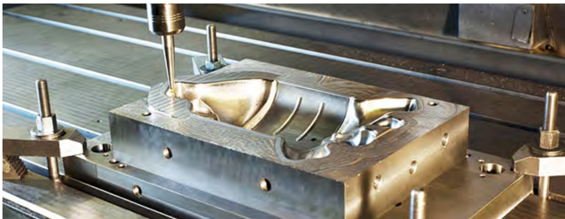
Rysunek 5 Przykład formy ciśnieniowej (źródło: https://virocast.pl/wp-content/uploads/2016/09/odlewnia-aluminium-formy-wtryskowe.jpg )
