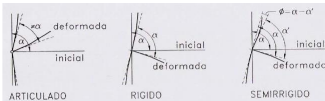
Ilustración 3.1: Tipos de nudos según su rigidez
