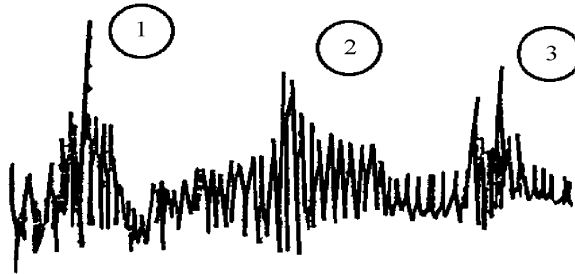
Obr. 6. 22 Vznik postranních frekvenčních pásem
