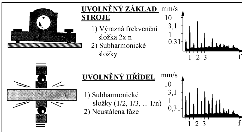
Obr. 6. 29 Uvolnění mechanických částí
