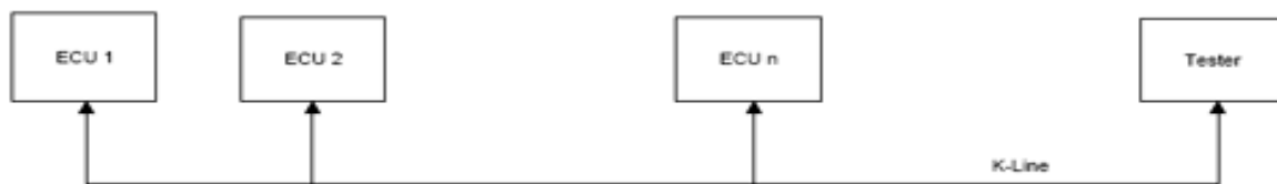
Obr. 12. 10 Obecné schéma propojení řídicích jednotek vozidla ke sběrnici K-line
