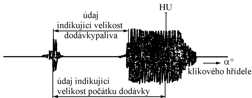
Obr. 9. 27 Průběh emitovaných ultrazvukových signálů vstřikovacího čerpadla
