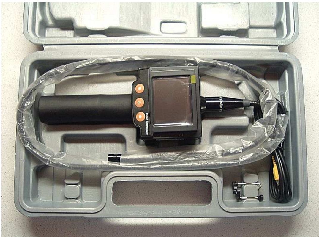
Obr. 10. 8 Technický endoskop s pevným tubusem
