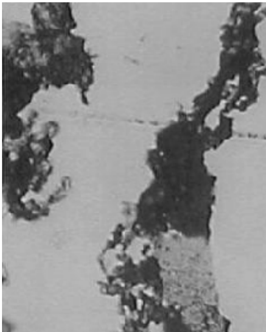
Obr. 8. 20 Částice mezního opotřebení, mají důlkovaný povrch po opakovaném průchodu valivým kontaktem. Vznikají v závěru únavového rozpadu Beilbyho vrstvy. Zvětšeno 500 x.
