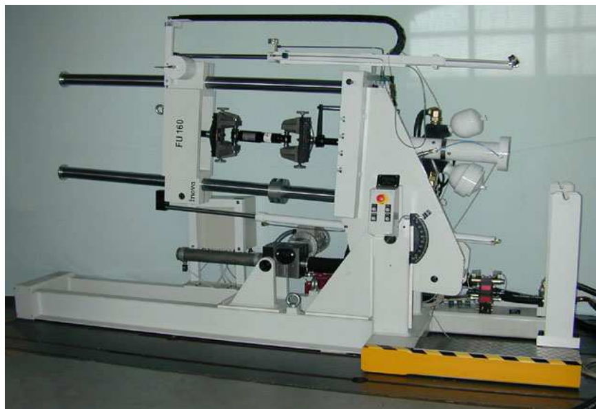
Obr. 11. 19 Provedení zkušebního stavu pro diagnostiku vymontovaných tlumičů
