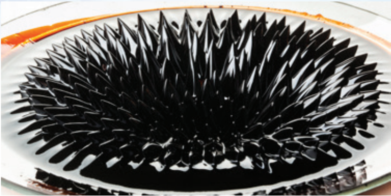
Obr. 23 Pri umiestnení magnetu pod tanier s magnetickou kvapalinou vznikne útvar nazývaný magnetický ježko, pretože častice sa usporiadajú v smere magnetických siločiar (Obr. uverejnený so súhlasom P. Kopčanského, Ústav experimentálnej fyziky SAV, Košice.)
