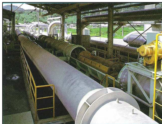
Obr.5 Pohled na koncovou stanici pro dopravu vápence v Japonsku. Matriál firmy SUMITOMO METALS
