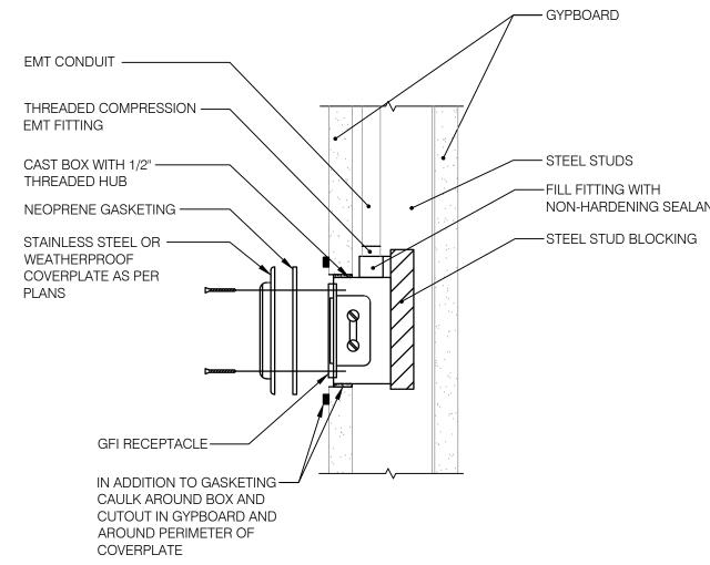
1 RECESSED CAST BOX INSTALLATION DETAIL NO SCALE
