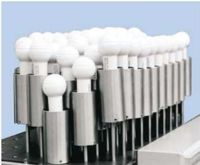
Obr. 8: 3-D zahřívací panel pro laminování dveřních obkladů
