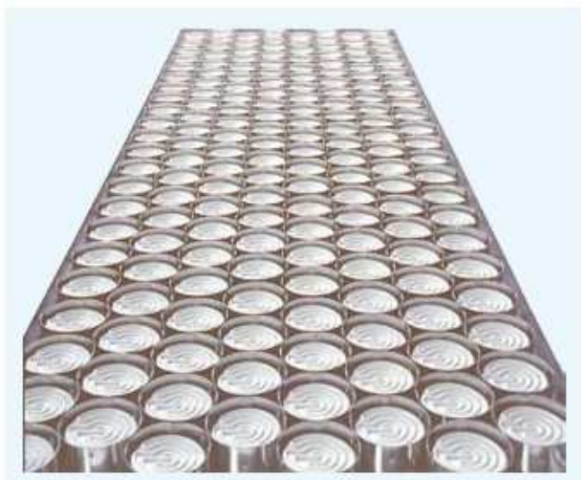
Obr. 27: Zahřívací plocha pro zahřívání dna láhvi
