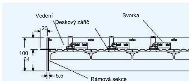
Obr. 83: Struktura stavebního panelu BSI Rozměry v mm
