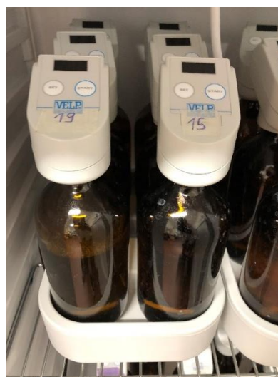
Figura 33: Chiusura delle bottiglie tramite l'utilizzo di tappi adibiti alla misura del BOD 5 e collocazione delle bottiglie all'interno degli agitatori
