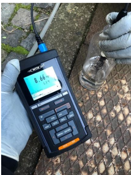
Figura 26: Misura OD tramite misuratore multi parametrico e sonda dedicata
