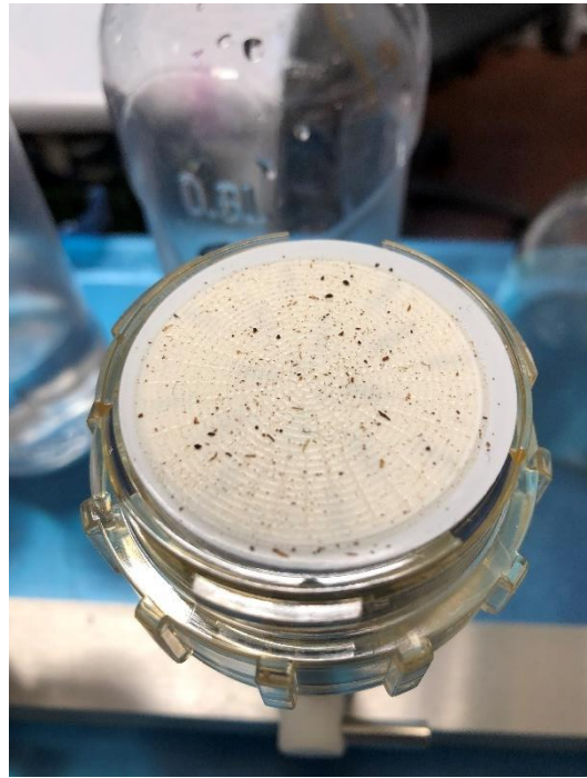
Figura 29: Filtro post microfiltrazione
