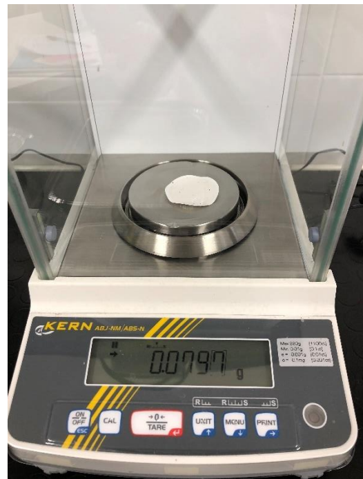
Figura 31: Determinazione del peso dei filtri post essiccazione su bilancia analitica
