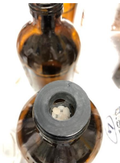
Figura 32: Idrossido di sodio in pellet inserito nei sotto-tappi in silicone
