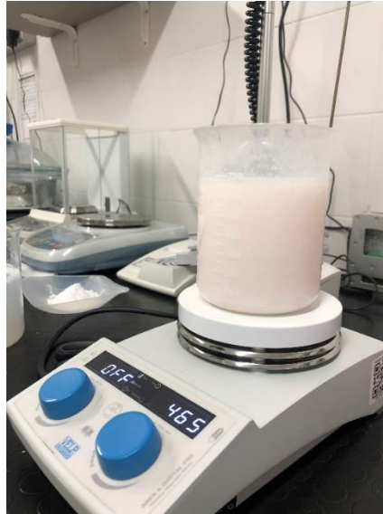
Figura 20: Preparazione dell'acqua grigia sintetica
