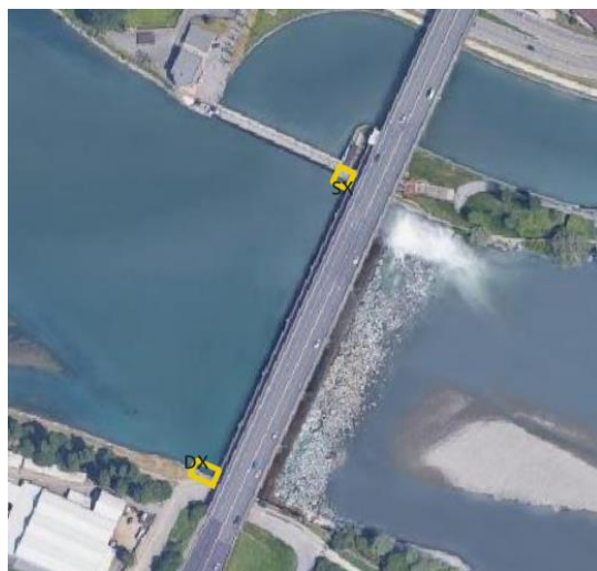
Figura 36: possibili configurazioni di installazione minihydro.
