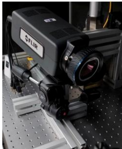
Figura 22 Termocamera con relativo sistema di fissaggio
