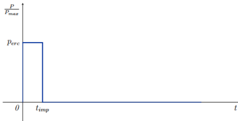
Figura 26 Modello di forzante usato nelle prove
