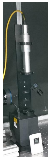
Figura 58: Sorgente laser e sistema di direzionamento
