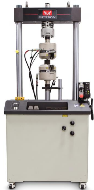
Figura 21: Macchina servoidraulica Instron 8801
