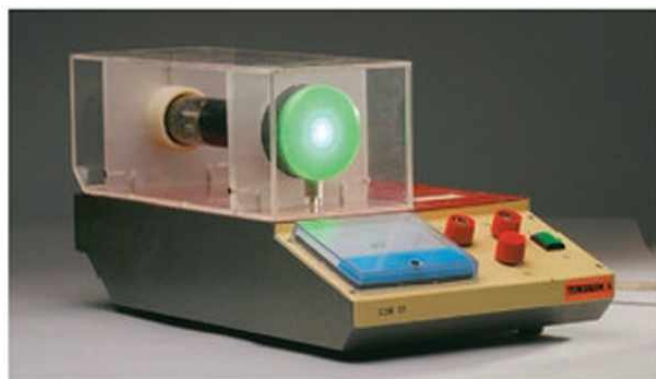
110.2. Elektron diffrakciós készülék. Hogyan változik az interferenciakép, ha a feszültséget növeljük?
