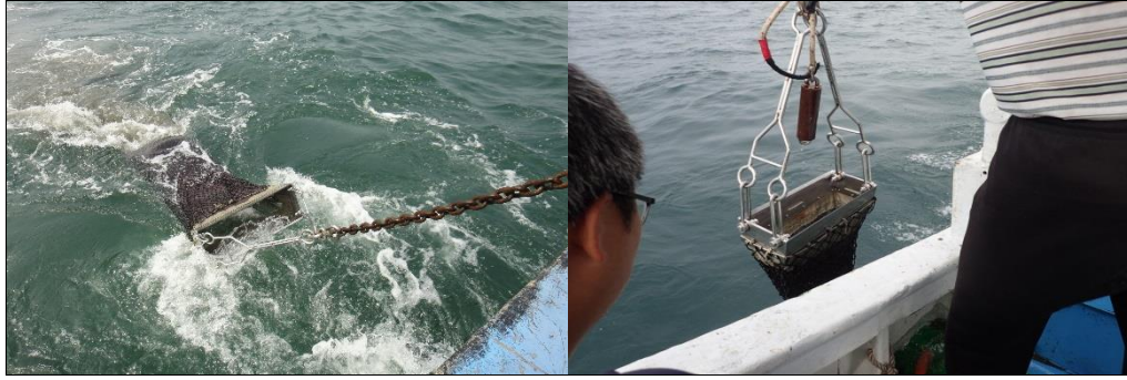
圖六、矩形底棲生物採樣器調查示意圖
