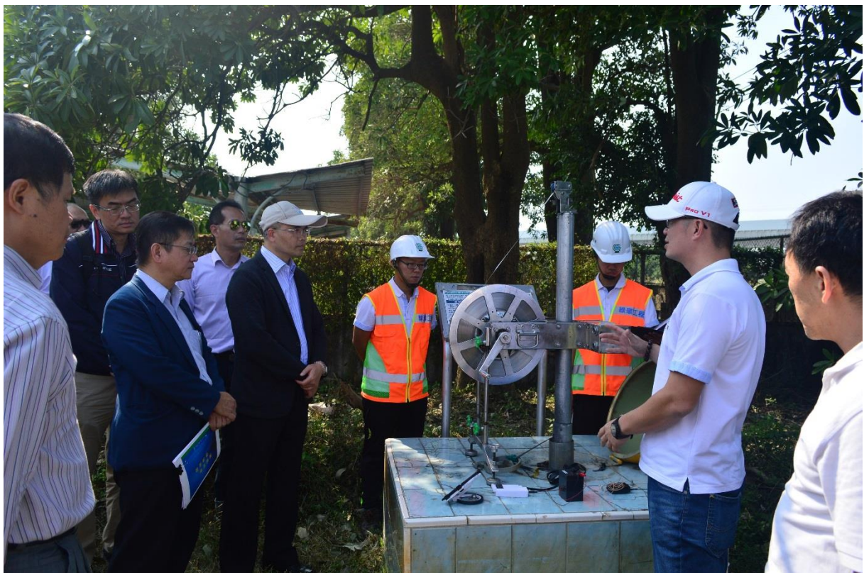
地層下陷磁環式分層監測井作業實測
