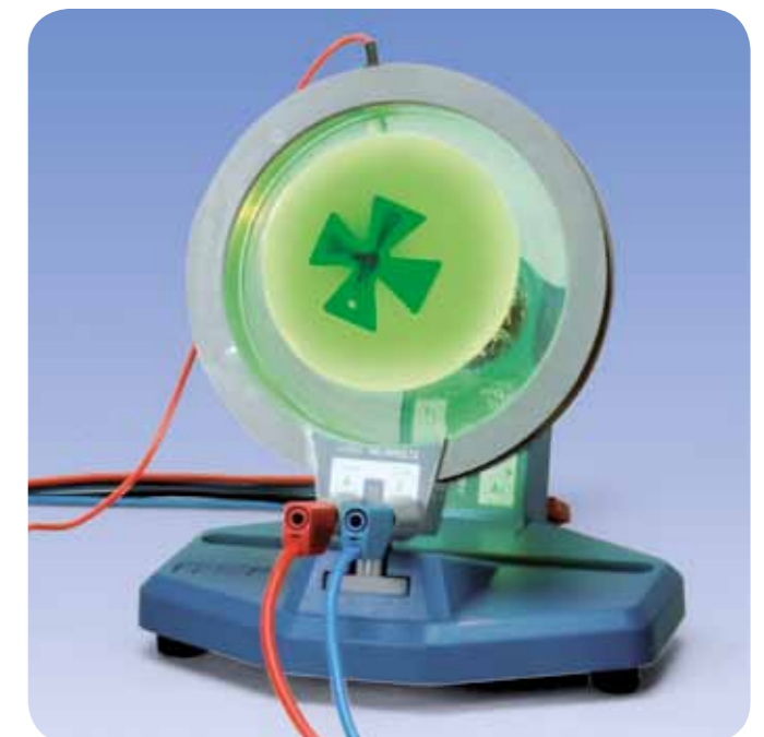
Fig. 2: Rotazione dell'ombra degli elettroni tramite deflessione degli elettroni nel campo magnetico
