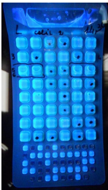
Figura 5: Enterolert dopo incubazione esposto a luce ultravioletta
