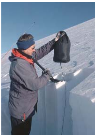
Esecuzione del test della pala dopo la rottura del blocco.
