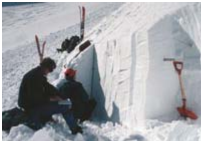
Esecuzione del profilo stratigrafico
