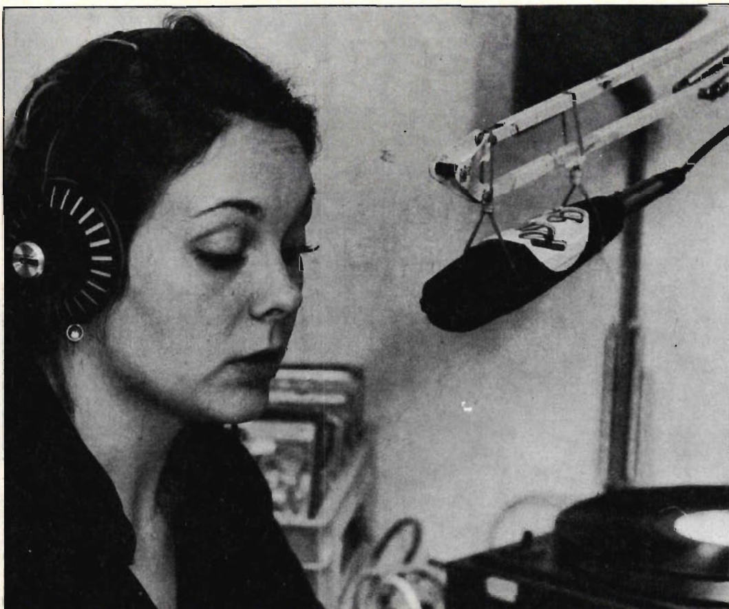
En närradiostudio måste vara billig att bygga upp. Därför måste man använda sin fantasi. Lägg märke till det primitiva med också effektiva mikrofonstativet: En kasserad skrivbordslampa i vilken mikrofonen hänger i gummisnoddar. Det dämpar väl resonanser och stötar.
