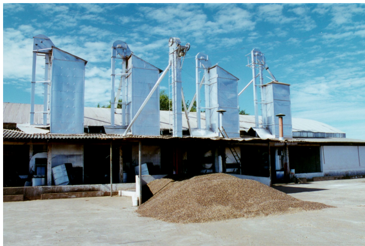
Figura 14 – Conjunto de secadores de fluxos cruzados com recirculação do produto.
