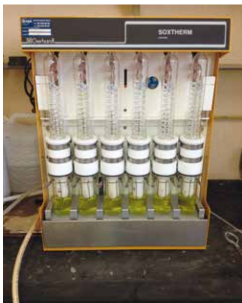
Extracción de aceite de aguacate con éter y en continuo.
