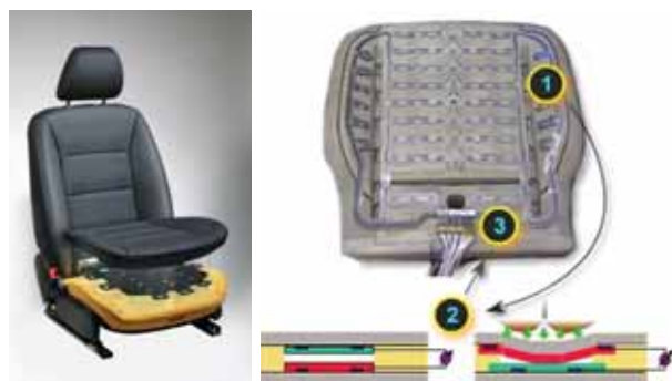
Obr. 2 Princíp senzorickej platne sedáku sedadla [10]
