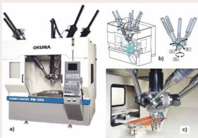
Obr. 2 Stroj Cosmo Center PM-600 s paralelogramovou štruktúrou a) pohľad na stroj, b) princíp stroja, c) detail pracovného priestoru
