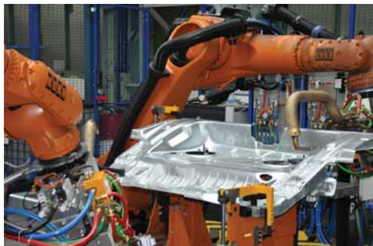
Zvarovacia bunka na zváranie podlahy pre VW Touareg
