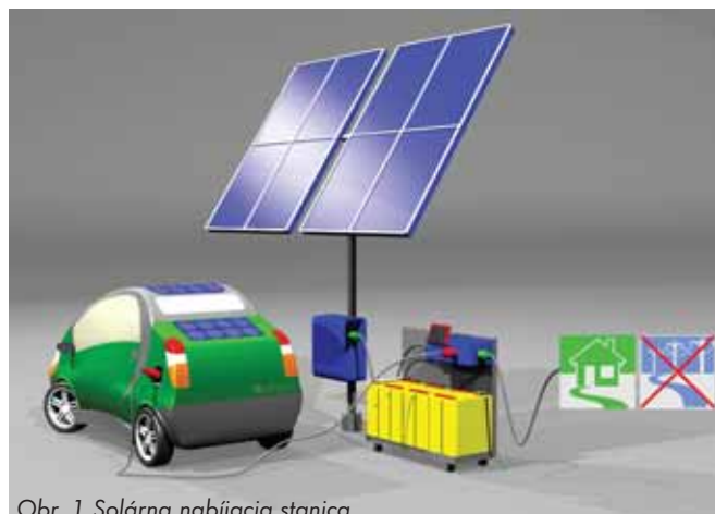
Obr. 1 Solárna nabíjacia stanica
