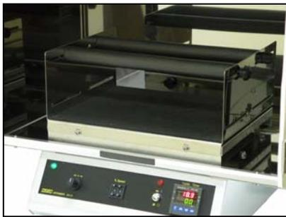
Detalle interior con la bandeja universal en U y dos rodillos de sujeción deslizables horizontalmente y en dos alturas distintas que permiten acomodar diversos utensilios como frascos, matraces, vasos, etc.
