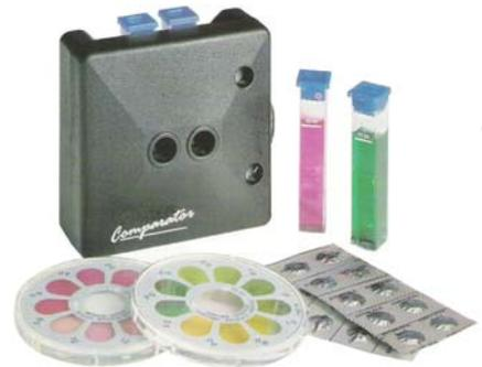
Se fabrica una amplia gama de Discos con colores muy resistentes a la luz que no se deterioran con el tiempo. Tanto el Comparador como los Discos se adaptan a las medidas internacionales siendo compatibles con la mayor parte de los Comparadores standard del mercado.
