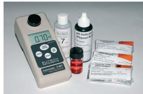
Método Fotométrico a 525 nm con emisor diodo LED
