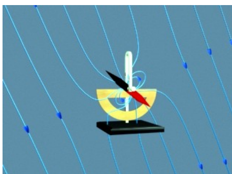
Obr. 8.4.5: Strelka kompasu jako dipól v magnetickém poli Země.
