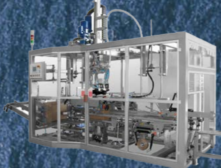
ΕΓΚΙΒΩΤΙΣΤΗΣ ΤΥΠΟΥ COMBI ΓΙΑ ΤΗΝ ΔΙΑΜΟΡΦΩΣΗ ΤΟΥ ΧΑΡΤΟΚΙΒΩΤΙΟΥ, ΤΟΝ ΕΓΚΙΒΩΤΙΣΜΟ, ΚΑΙ ΤΗΝ ΚΟΛΛΗΣΗ ΤΟΥ ΧΑΡΤΟΚΙΒΩΤΙΟΥ.
