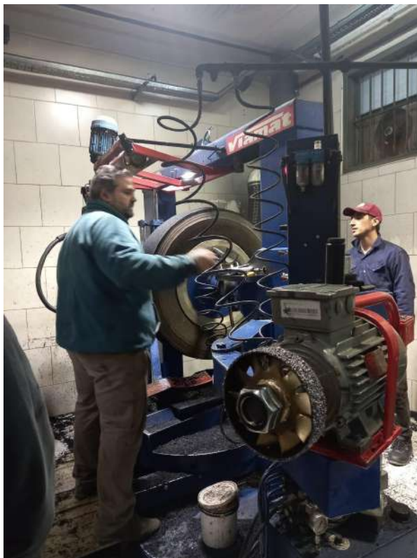
5. Pulido de la banda de rodamiento (tienen dos equipos de raspado para trabajar en paralelo) y nueva revisión de calidad.
