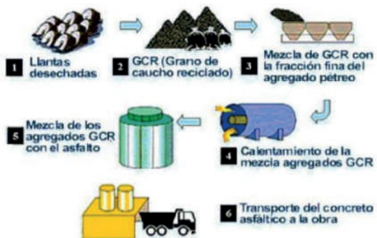
Figura A1F6. Proceso de producción por vía seca de asfalto modificado
