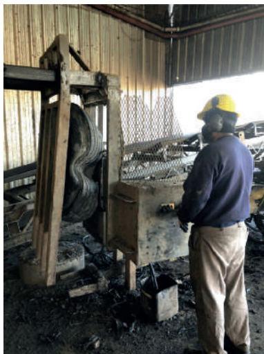
2. Destalonado, retirando un anillo de alambre a través de un gancho hidráulico.
