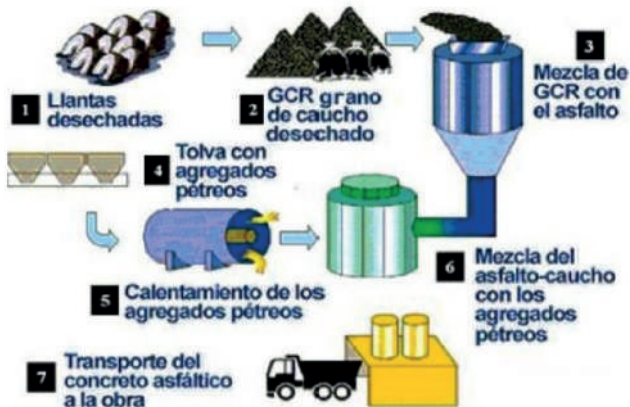
Figura A1F4 Proceso de producción por vía húmeda de asfalto modificado
