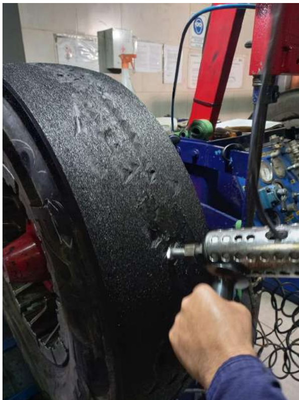
6. Cementado de la banda de rodamiento con pistola de caucho a 70 / 80 °C para nivelar la superficie antes de la adhesión de la banda de rodamiento.
