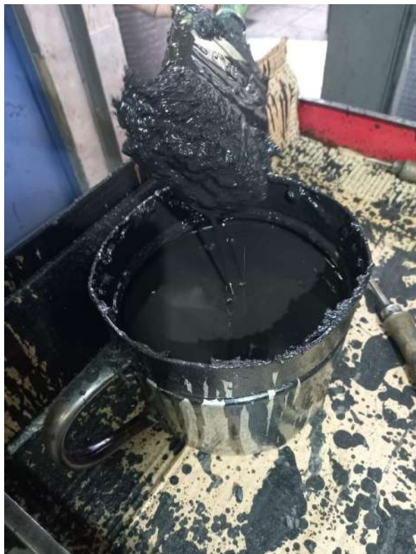
7. Pintura "flu" para nivelar.
