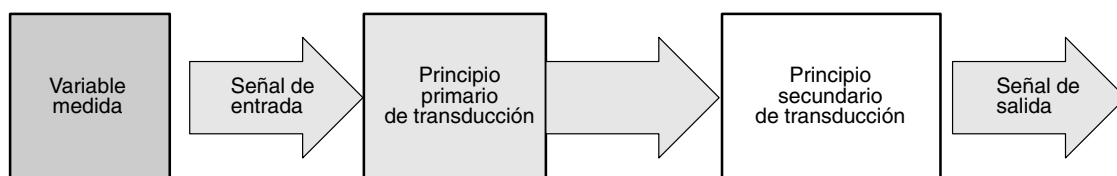
Figura 28-18. Estructura genérica de un sensor. El sensor puede utilizar uno o más principios de transducción con el fin de producir una salida útil en respuesta a la cantidad, la propiedad o la condición física que se desea medir.
