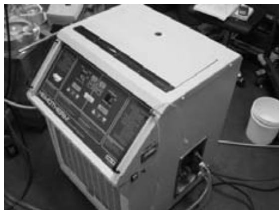
Figura 36-5. Intercambiador de temperatura (Hemotherm Cooler-Heater CSZ®).
