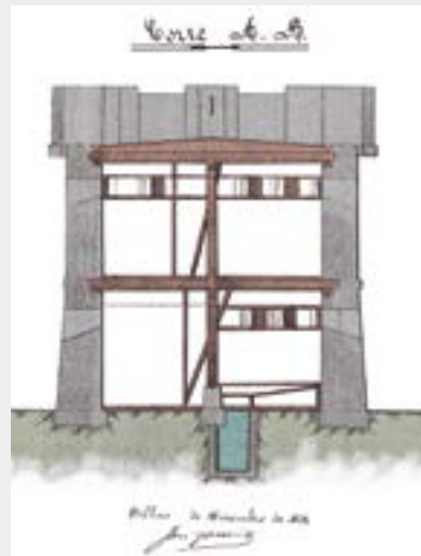
Plano con el alzado interior del torreón del monte Serantes, fechado en 1878.
