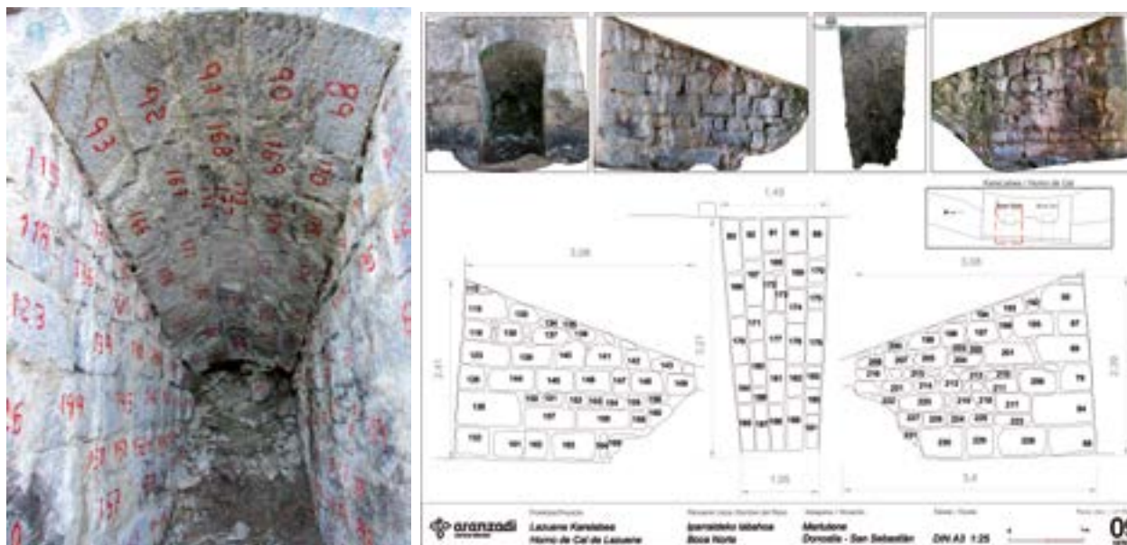
Proceso de marcado de uno de los pasillos y plano de registro del Horno calero de Latsuene (Donostia). © A. MORAZA-E. ALONSO
