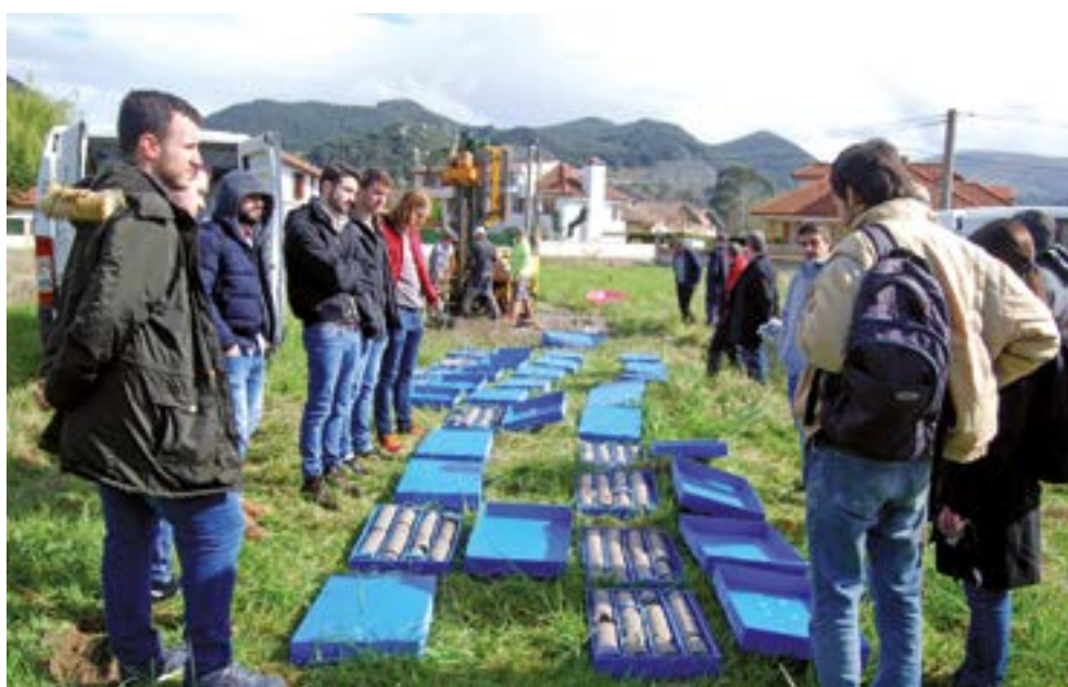
Testigos del sondeo perforado en Liendo (Cantabria).
