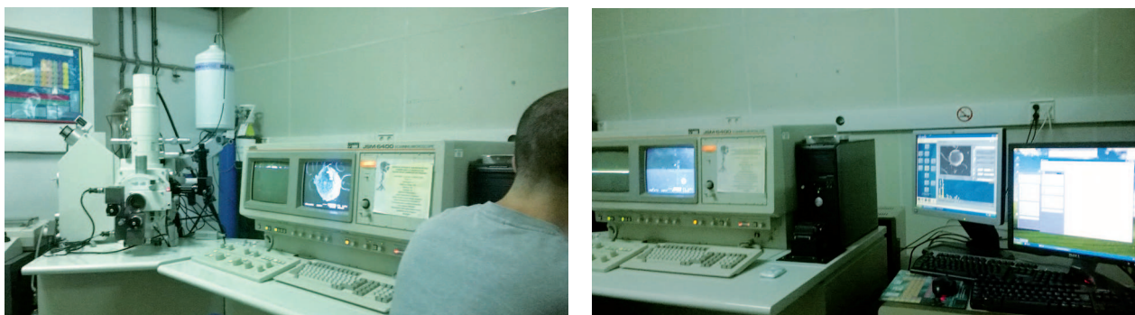
Figura 6. A la izquierda, vista general de los servicios de microscopía electrónica de barrido. A la derecha, ordenador al que se importan las imágenes del SEM, y donde se obtienen los datos de Energía Dispersiva de Rayos X (EDX).
