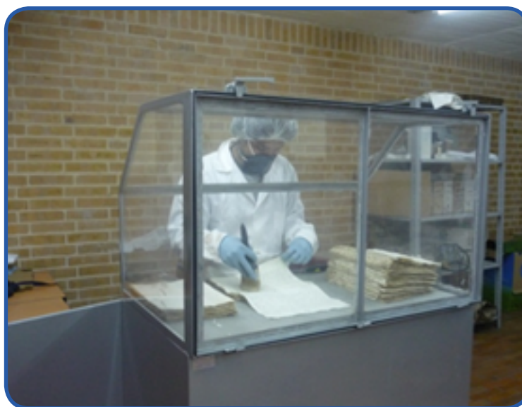
Foto 3. Modelo de cabina para limpieza de documentos.
